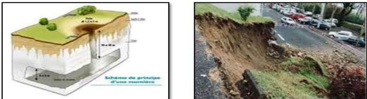
(a) : mécanisme de l'effondrement
