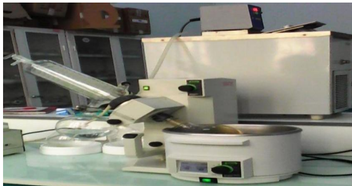
Figure08 : Un rotavapeur rotatif type (BÜCHI R- 210).
