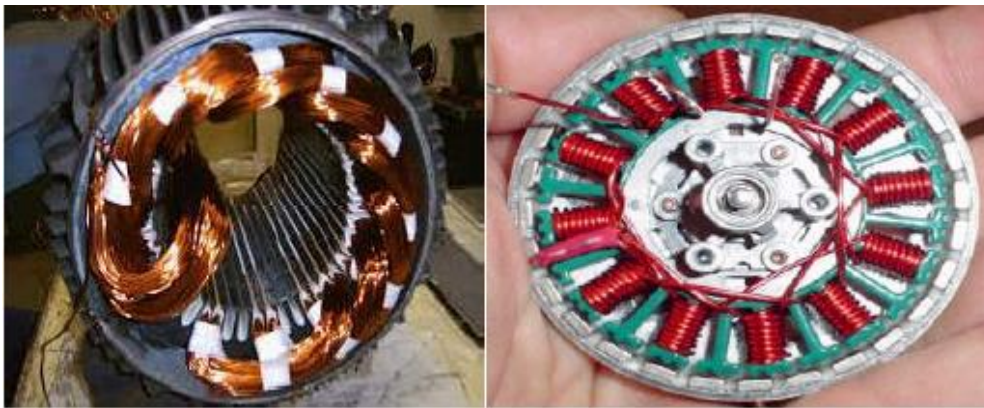
Figure I.9 : Bobinages de différents moteurs
