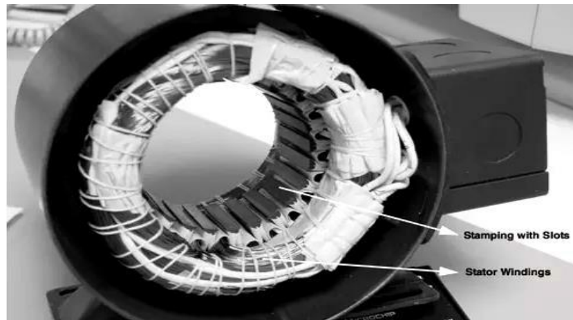
Figure I.8 : Stator du moteur à courant continu sans balais.
