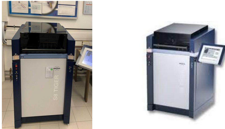
Figure 30: Appareil de fluorescence des rayons X S8 disponible au laboratoire d'analyse de LAFARGE.
