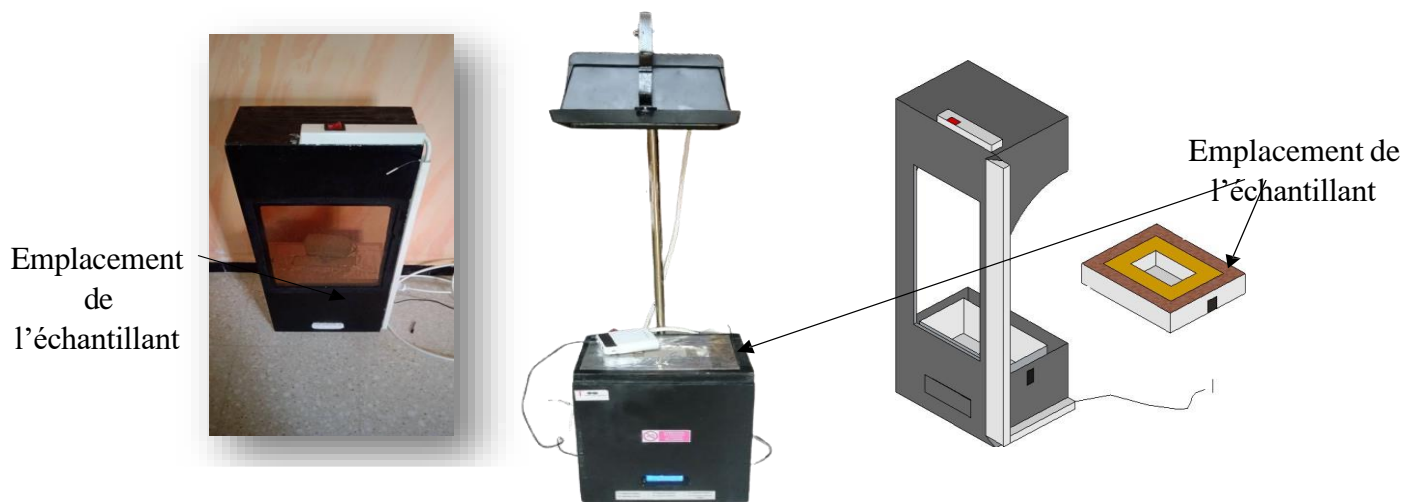
Figure 54 :Dispositif de détermination des propriétés thermiques des matériaux de construction (Conductivité thermique, diffusivité thermique, capacité thermique).
