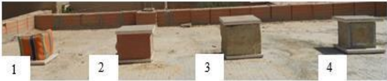
Figure 16: Quatre chambres différentes faites de laine de mouton (1) (tente), de brique ordinaire (2), de brique de terre (3) et de calcaire (4) .
