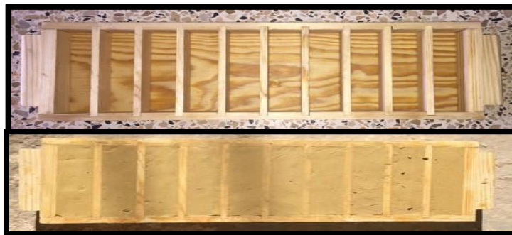
Figure 20: Le moule en bois utilisé pour fabriquer les échantillons
