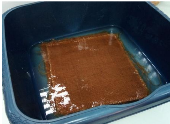
Figure.III.9 : la neutralisation des tissus (Solution 2% H_2SO_4 / 10 min)
