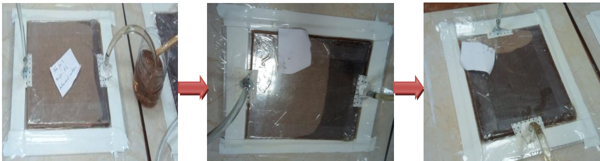
Figure. III.15 : Le processus de passage de la résine
