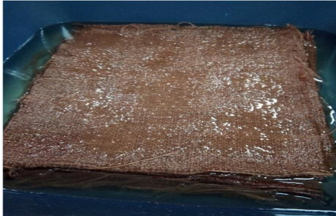
Figure. III.4 : Imprégnation des tissus (Solution 1% NaOH / 48 H)
