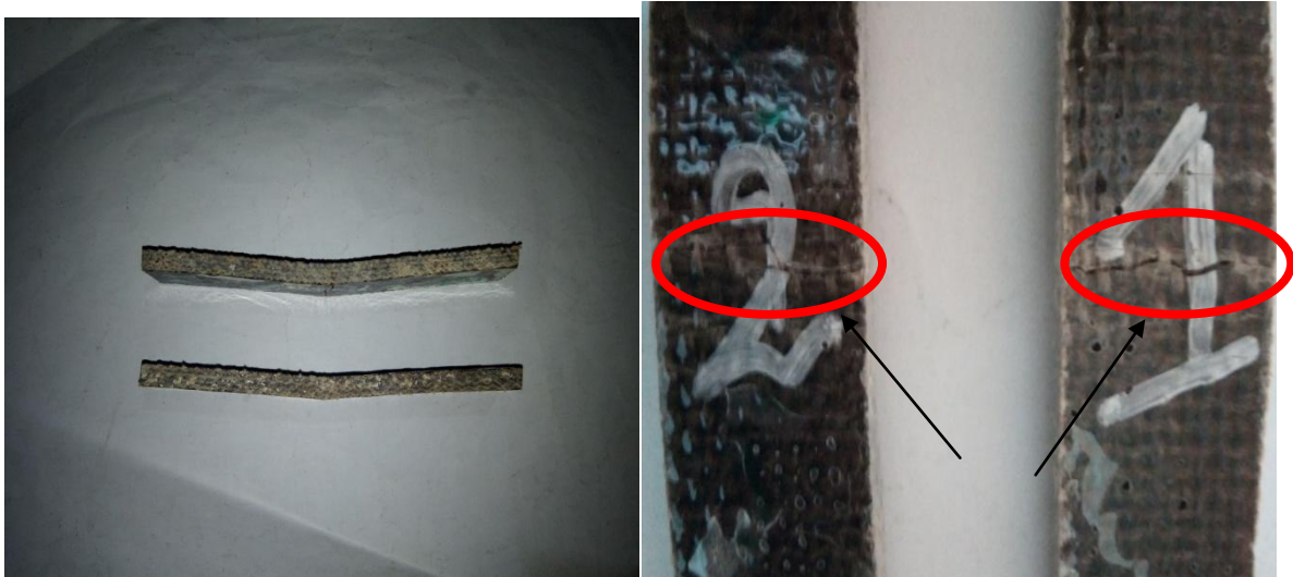
Figure IV.16 : Image de la fissure par les tissus de jute en flexion 3 points
