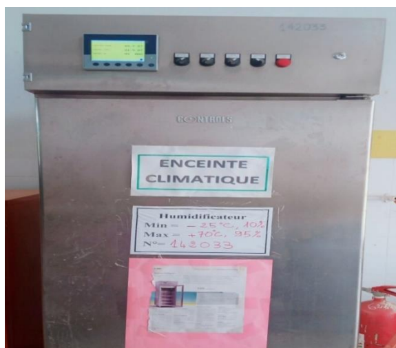
Figure III.20 : chambre de cure (Température, Humidité) Laboratoire géo matériaux M'sila
