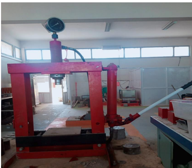
Figure III.19 : Presse manuelle du laboratoire de développement Géo matériaux, Université de M'sila.
