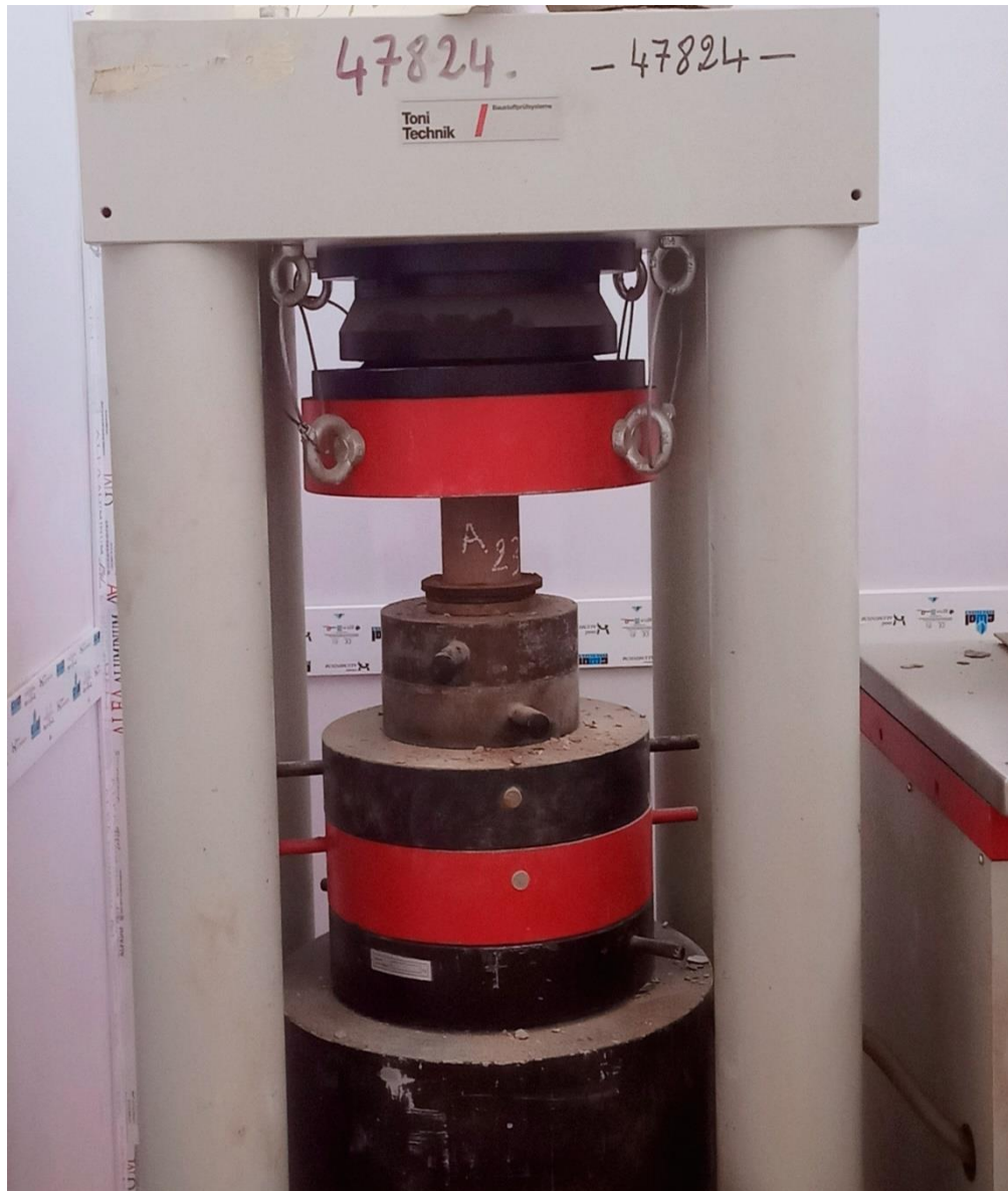
Figure III.23 : presse hydraulique (Laboratoire géo matériaux M'sila)
