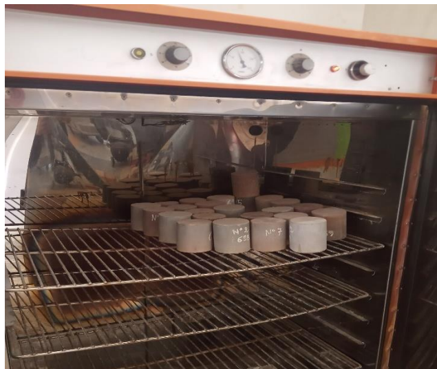
Figure III.22 : étuve du laboratoire de développement Géo matériaux, Université de M'sila.
