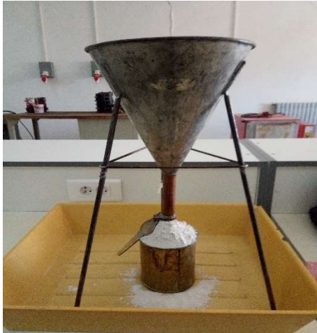
Figure IV.2 : Dispositif pour l'essai de récipient et entonnoir à trépied.
