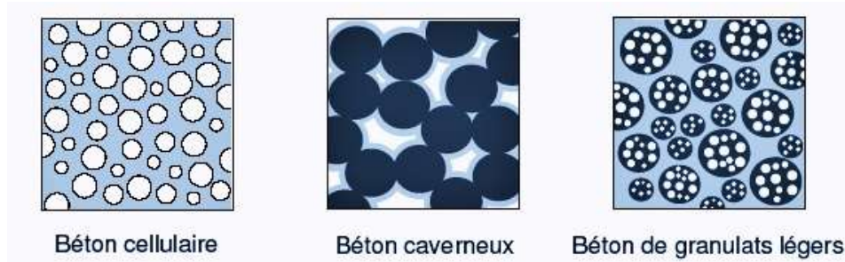
Figure I.1 : Représentation schématique des différents types de béton léger [6].
