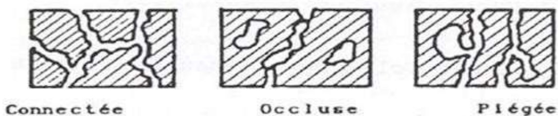
Figure I.5 : Trois types de porosité présente dans les matériaux [17].
