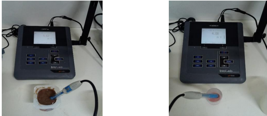
Figure 11: Mesure de pH des produits (yaourt et crème dessert) pH-mètres INOLAB 731
