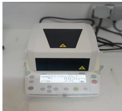
Figure 12: Dessiccateur SHIMADZU série MOC63
