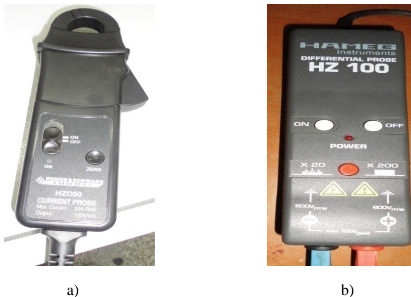
Figure 4.16. Photographie des capteurs, a) capteur de courant, b) capteur de tension.
