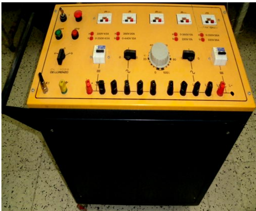
Figure 4.4. Photographie de l'autotransformateur.
