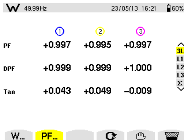
Figure 2.55. Facteur de puissance après filtrage des trois phases du réseau.
