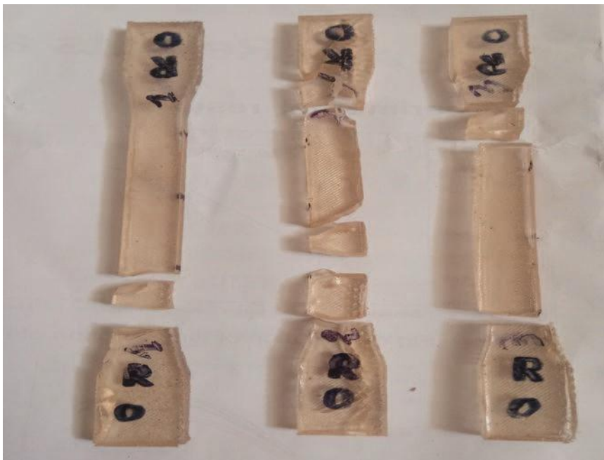
Figures III.11 : Éprouvettes de traction après rupture.
