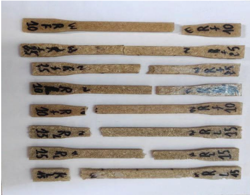
Figure III.3:Éprouvettes de traction après rupture.
