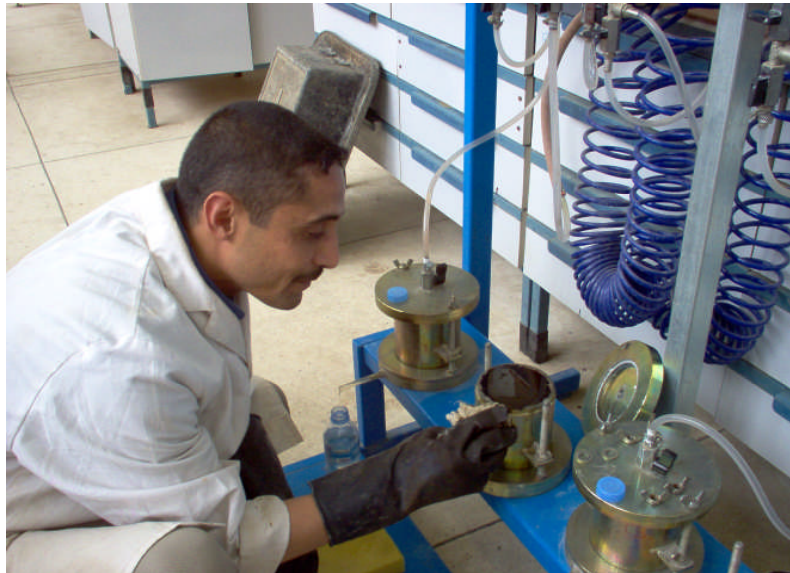
Photo.4.10 : Mise en marche de l'essai d'infiltration.
