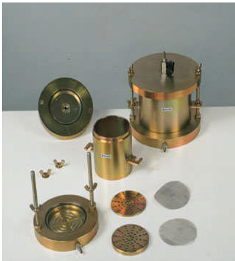
Photo 4.8: Support pour perméamètre et accessoires
