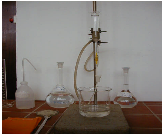
Photo.4.4 : Capacité d'échange cationique (C.E.C.) déterminée par la méthode de percolation à l'acétate d'ammonium.
