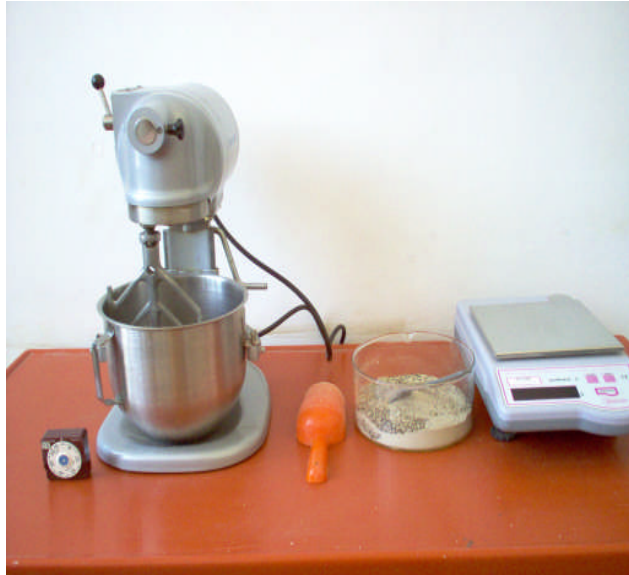
Photo. 4.7 : Malaxage du mélange Sable-Bentonite
