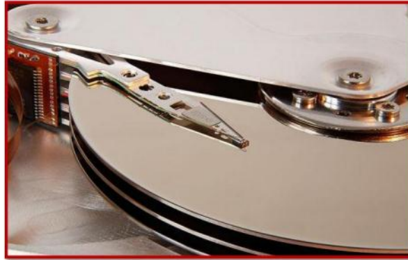
Figure (I.7) : Détail d'un bras avec sa tête reposant sur un plateau de disque dur.
