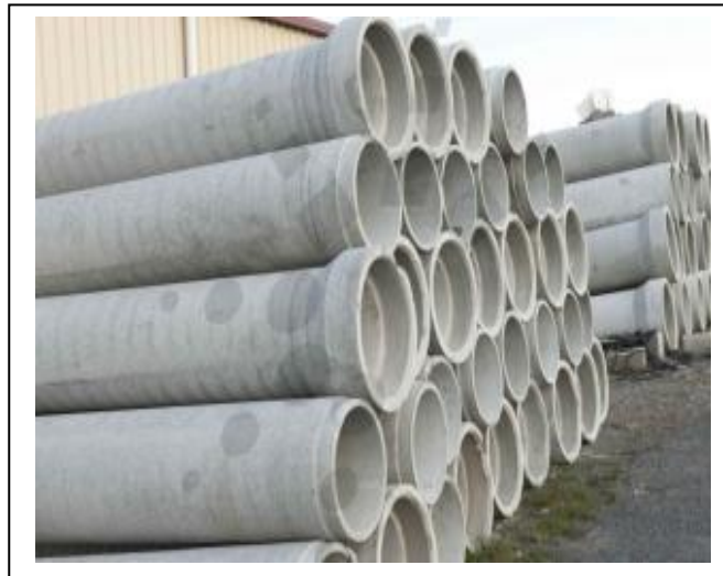
Figure : conduite en béton armé.
