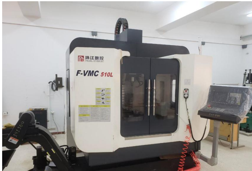
Figure II.1 : Centre d'usinage 4 axes.
