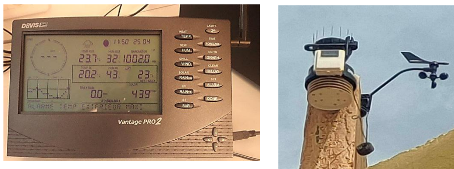
Fig. 3.6 Station météorologique de type Davis
