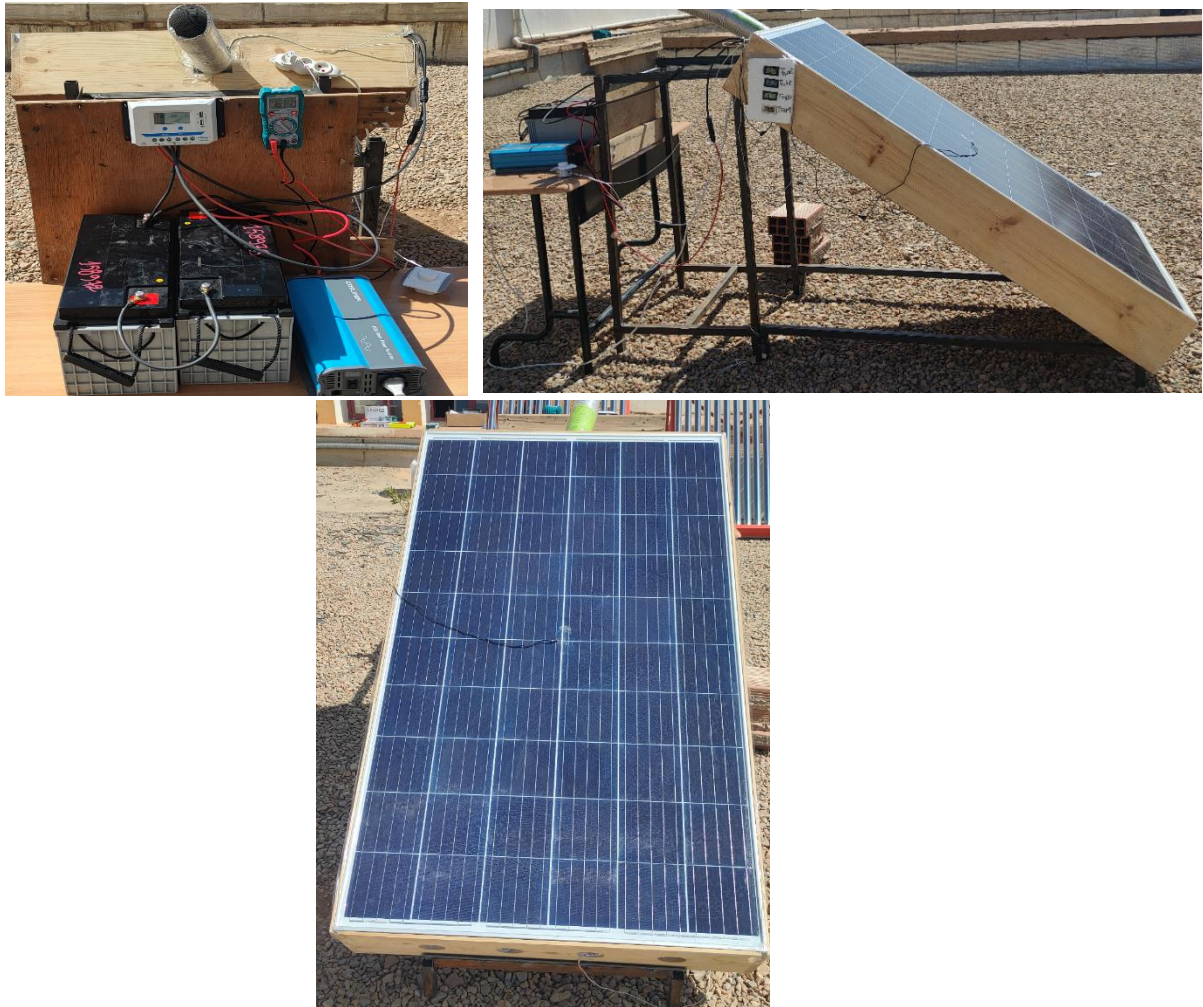
Fig. 3.10 Banc d'essai en charge du capteur solaire hybride PV/T à air.
