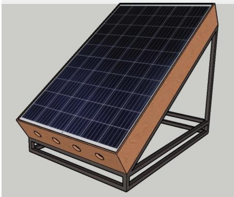
Fig. 3.1 Schéma du capteur hybride PV/T à air
