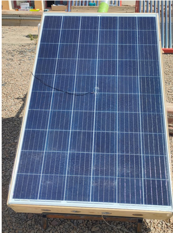
Fig. 3.4 Banc d'essai du capteur solaire hybride PV/T à air
