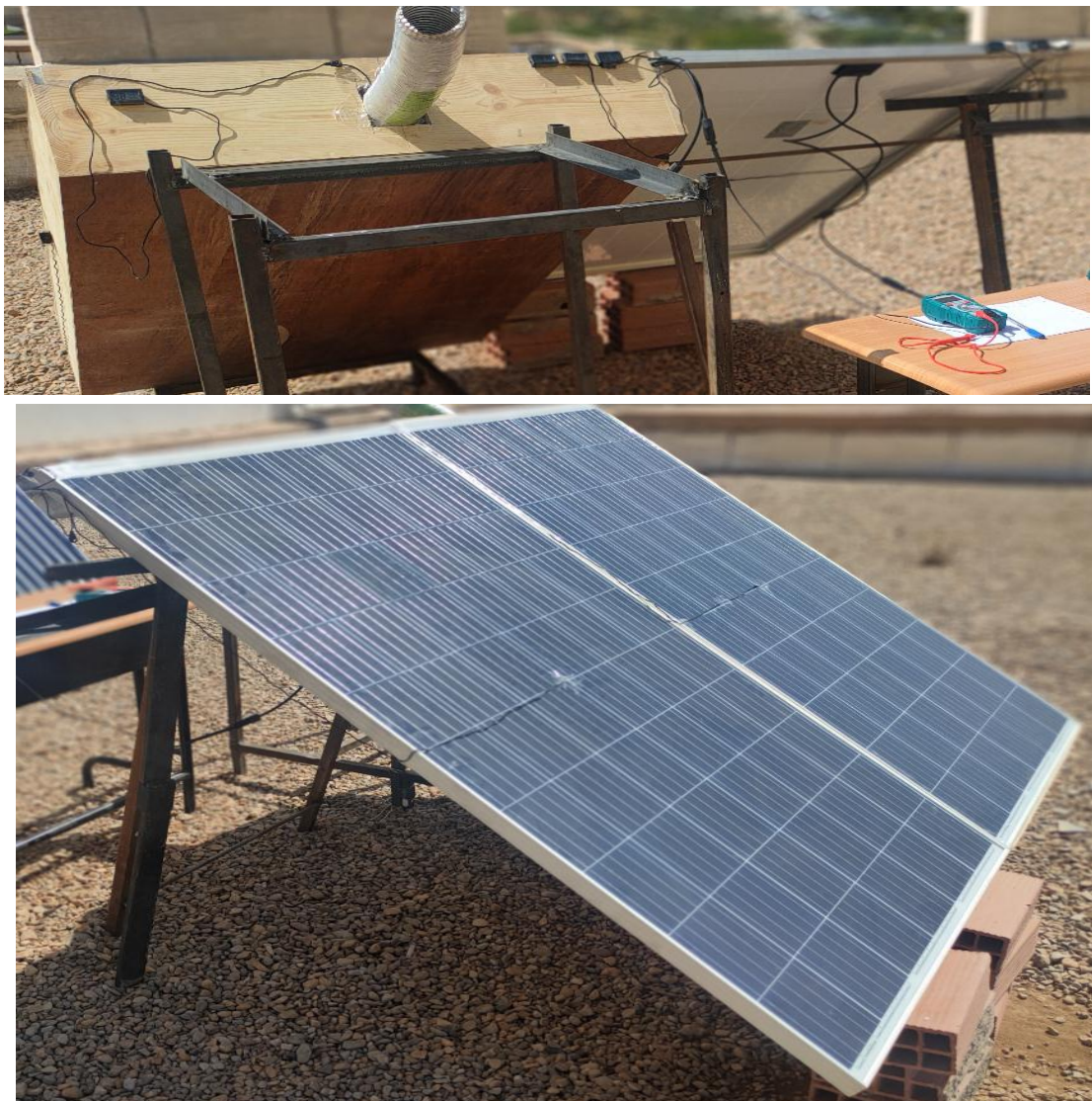
Fig. 4.2 Banc d'essai du capteur solaire PV/TH hybride et PV à vide [3-5]
