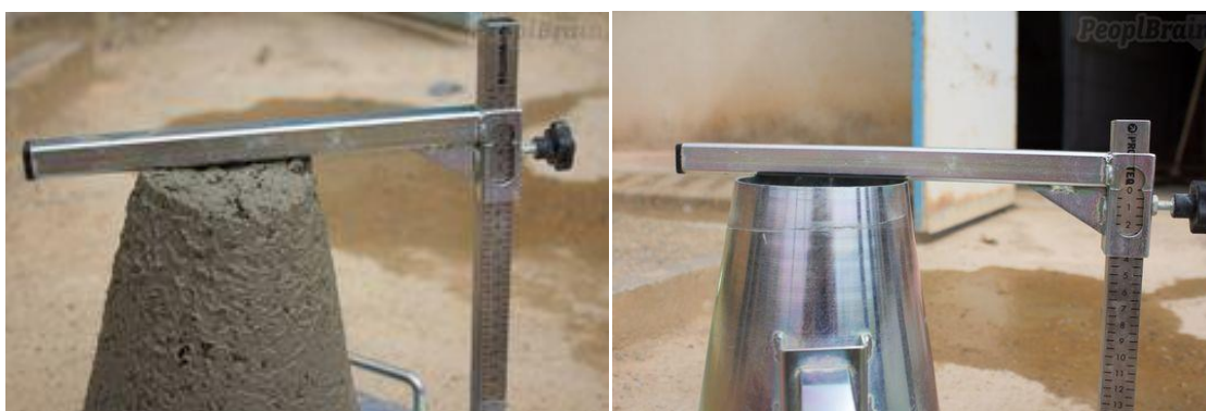
Figure I.6 : Mesure de l'affaissement
