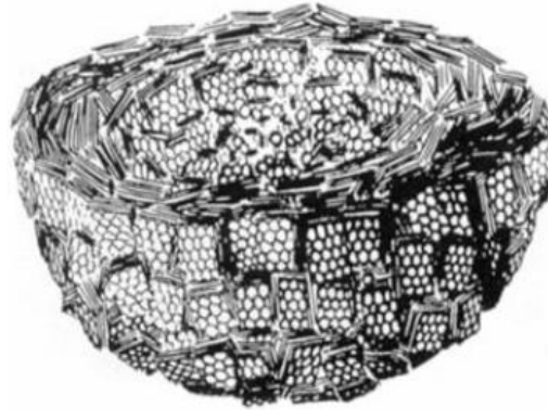
Figure 1.18 – Vue en coupe d’une particule de noir de carbone.
