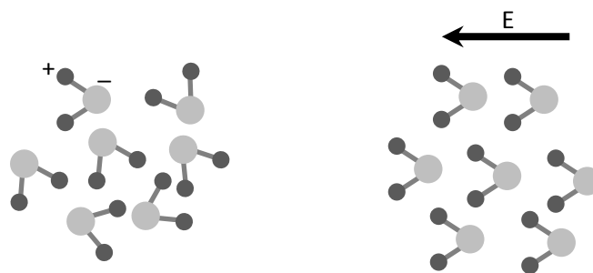
Figure 1.4 – Représentation schématique de la polarisation dipolaire.
