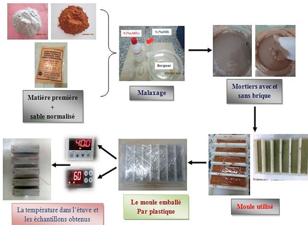
Fig IV.13 : Le protocole de préparation des mortiers de géopolymères dans une étuve à 40 et 60 °C pendant 24h.
