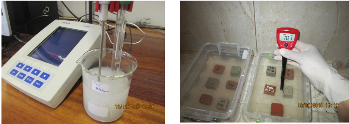
Fig IV.32 : Technique de mesure le PH mètre sur les poudres en l'eau distillées et sur les éprouvettes au milieu agressif du sulfate de sodium ( \text{Na}_2\text{SO}_4 ).
