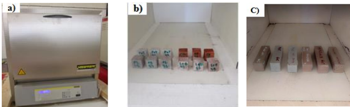
Fig IV.26 : a) le four à haute température, b) et c) les éprouvettes de pâtes et de mortiers dans le four pour le traitement thermique.
