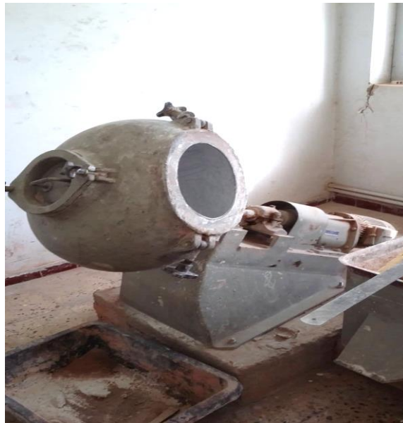
Fig IV.6 : Broyeur à boulets utilisé à l'université de Badji Mokhtar/ Annaba pour l'obtention des poudres minéraux.
