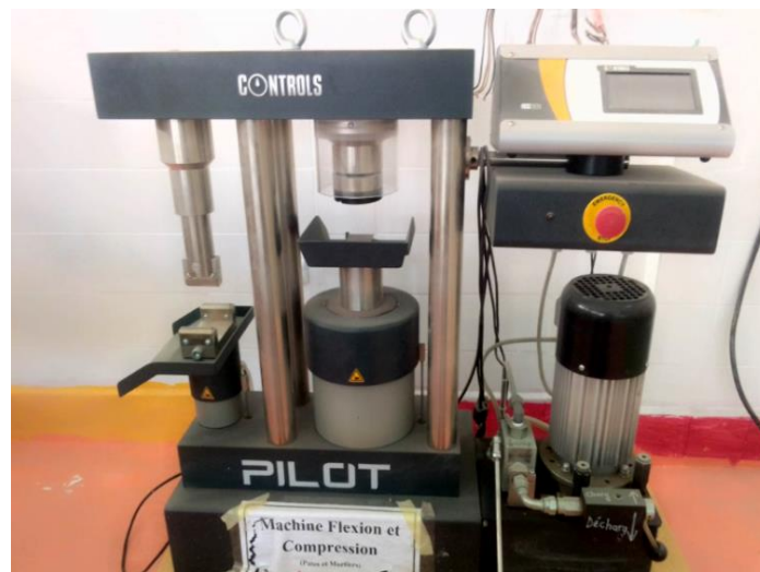
Fig IV.18 : La machine de compression et de flexion au niveau du laboratoire (LDGM) université de M'sila.
