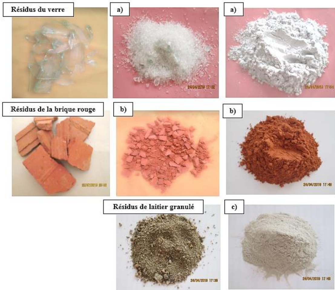
Fig IV.7 : La forme des résidus minéraux utilisés avant et après le broyage : (a) le verre et (b) la brique rouge (résidus inertes), (c) les résidus de laitier granulé.
