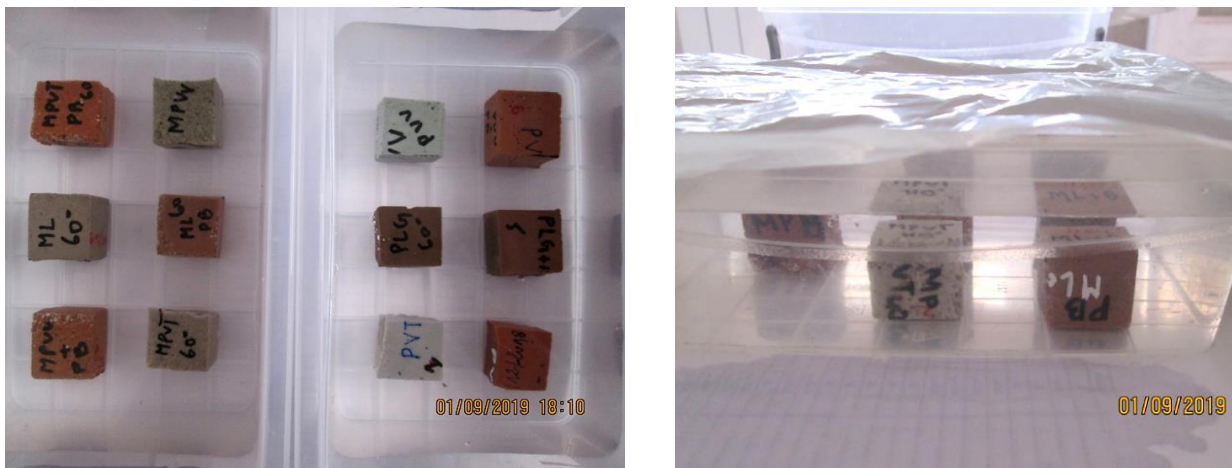
Fig IV.31 : Les éprouvettes des pâtes et des mortiers immergés totalement dans la solution sulfate du sodium ( \text{Na}_2\text{SO}_4 ).
