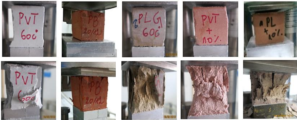
Fig IV.19 : L'essai de compression sur les pâtes de géopolymères à 60 °C.
