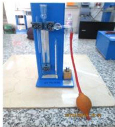
Fig IV.8 : L'appareil de Blaine de l'université de BBA ( Bordj Bou Arreridj ).
