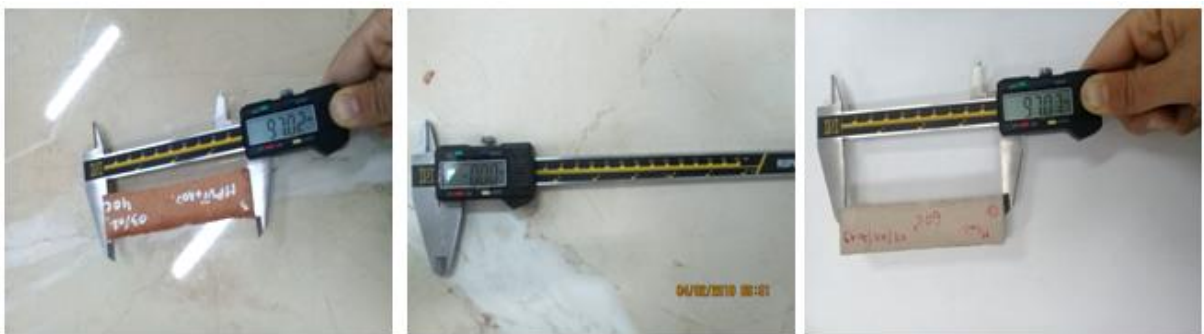
Fig IV.15 : Les dimensions mesurées « a , h et l » par pied à coulisse de chaque éprouvette.
