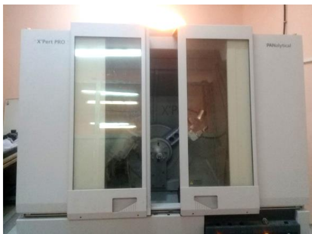
Fig IV.22 : L'appareil de DRX type « Panalytical X'Pert Pro » à l'université de M'sila.
