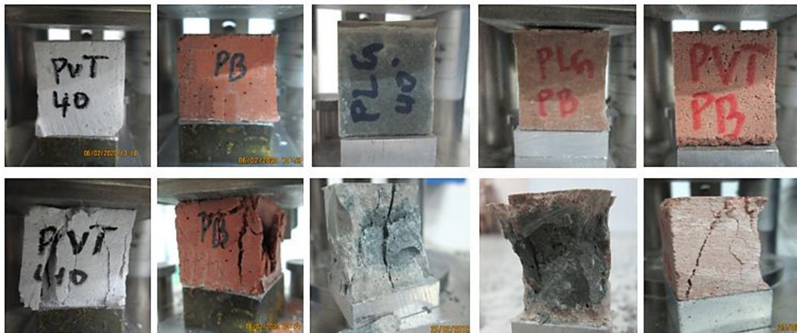
Fig IV.20 : L'essai de compression sur les pâtes de géopolymères à 40 °C.
