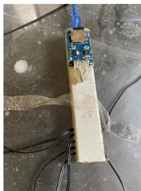
Figure(II.4b) : Le deuxième système d'acquisition des températures.
