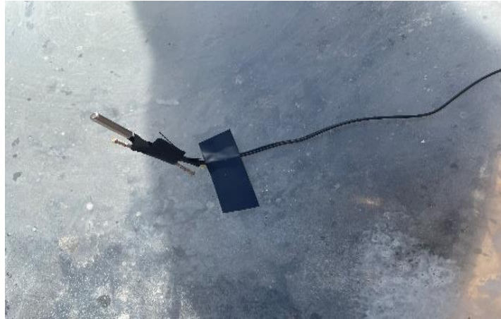
Figure (II.5.a) : Le capteur de température sur le collecteur.
