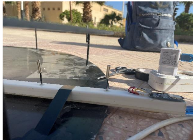
Figure (II.5.c) : Le système de mesure de température le long du rayon R du collecteur.
