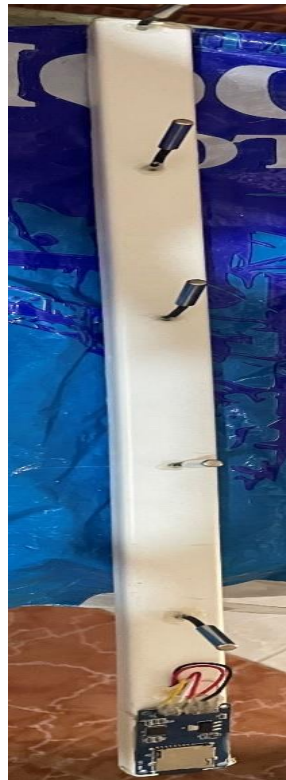
Figure (II.4a) : Le premier système d'acquisition des températures.
