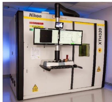
d) Station CT à distance
