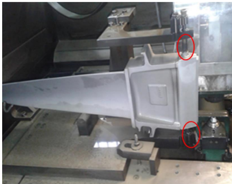
Figure IV 4: Dispositif d'usinage destiné à usiner le pied de sapin par électroérosion à fil (EDM)
