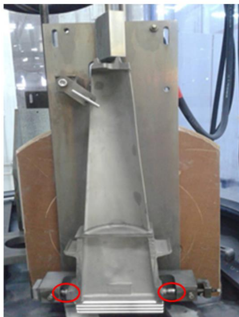
Figure IV 3: Dispositif d'usinage pour le perçage des trous de refroidissement au niveau de la pale d'ailette par ECD
