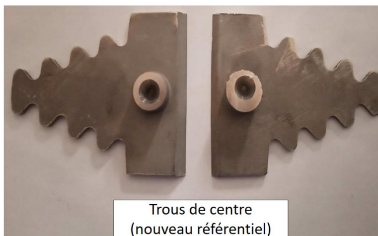
Figure V. 23: Trous de centre (nouveau référentiel) après découpage par EDM.
