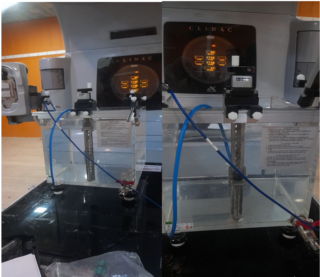
Figure3.15: Mesure de la dose absolue à l'aide d'un fantôme à eau et d'un accélérateur.
