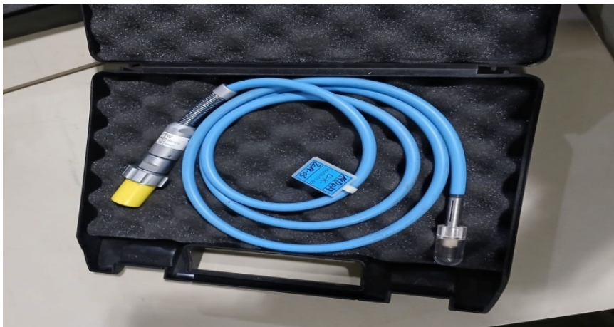
figure 3.3: Chambre d'ionisation SEMIFLEX PTW 0,125 cm 3
