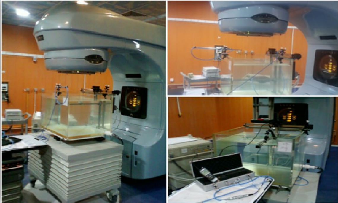
Figure 3.14: cuve à eau en cours de montage.
