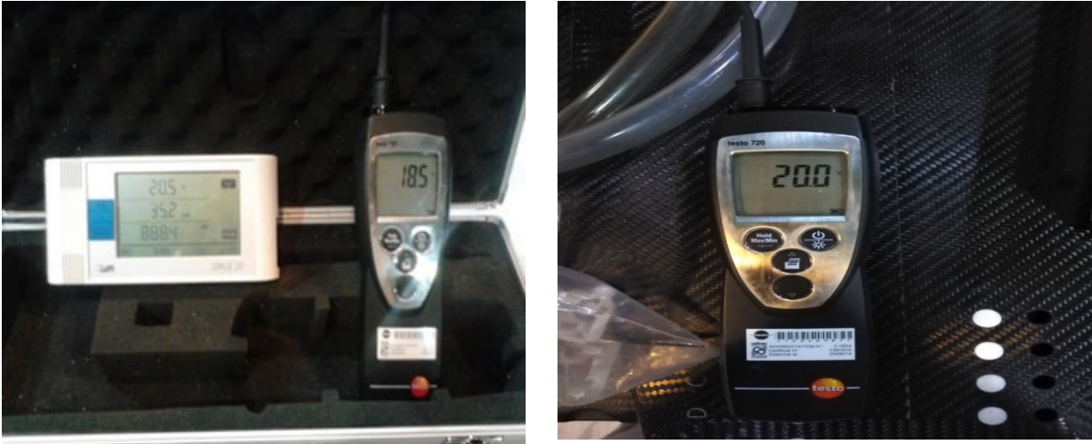
Figure 3.10: Baromètre et thermomètre .
