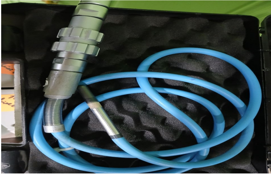
figure3.4: Chambre d'ionisation SEMIFLEX PTW 0 ,3 cm 3
