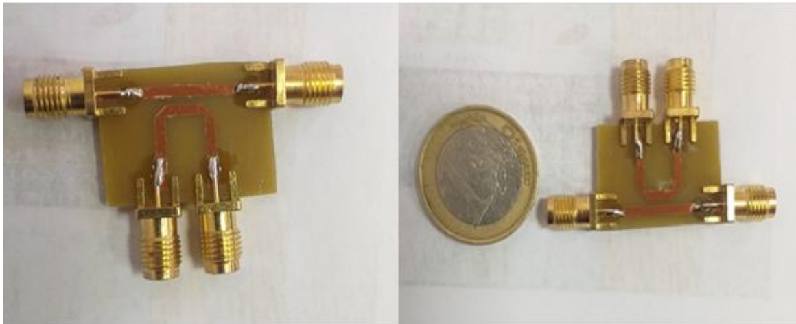
Fig.III.55. (a) Coupleur après soudage des connecteur SMA, (b) Comparaison du coupleur avec un EURO
