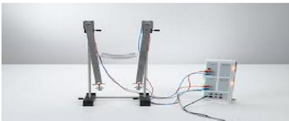
Fig.I.16. Oscillateurs à Couplage Inductif
