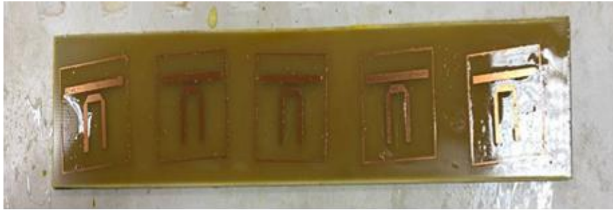
Fig.III.54. Le coupleur Finale avant le découpage
