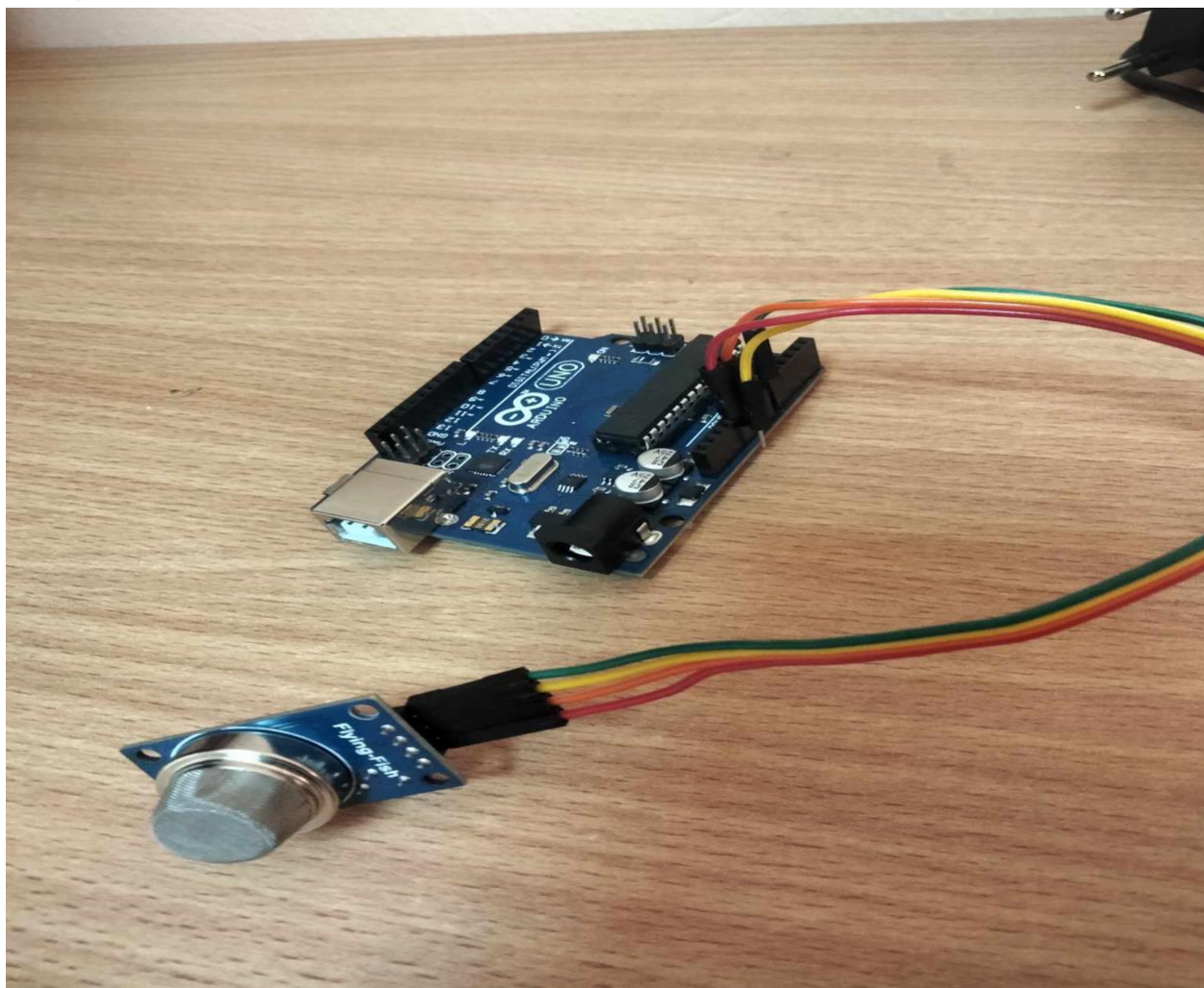
Figure n° 18 : Connexion capteur MQ2 sur L'ARDUINO
