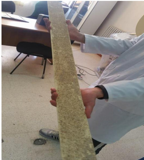
Photo 3.4 : Echantillon de grains de gravier de rugosité équivalente \varepsilon = 4,5\text{mm} .
