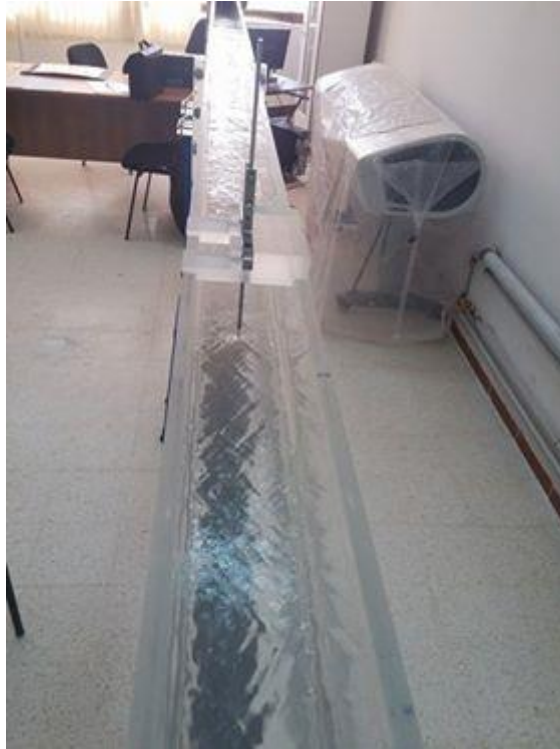
Photo 3,2 : l'écoulement évoluant dans un canal rectangulaire à pente variable à fond lisse . Vue de l'amont.
