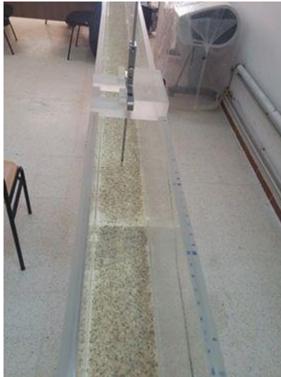
Photo 3.5 : Grains de gravier uniformément répartis sur le fond plat du canal rectangulaire à pente variable testé .
