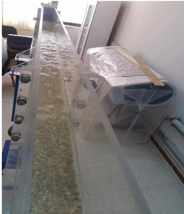
Photo 3.3 : l'écoulement évoluant dans un canal rectangulaire à pente variable à fond rugueux. Vue de l'aval .
