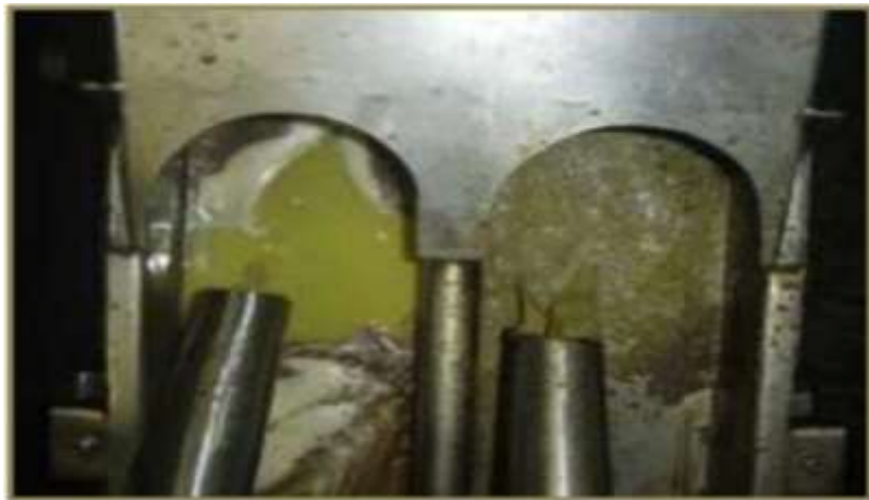
Figure 2: sortie d'une centrifugeuse 3 phases, à droite les grignons humides, à gauche l'émulsion huile/eau [Veillet S. 2010. Enrichissement nutritionnel de l'huile d'olive : Entre Tradition et Innovation. These de Doctorat en Sciences de l'Université d'Avignon et des Pays de Vaucluse. 153 pp.]
