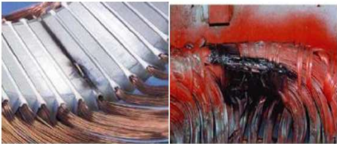
Figure III.8 Exemples de dégâts dus au défaut de court-circuit statorique d'un moteur asynchrone[15]
